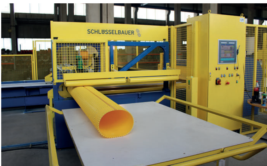
Ленты футеровки свариваются в цилиндрические вкладыши в полностью автоматическом режиме
